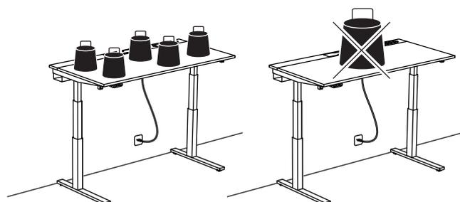
При регулировании высоты столешницы следуйте этим инструкциям:
