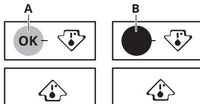
Správne uskladnenie potravín v chladničke umožňuje indikátor teploty. Symboly na bočnej stene spotrebiča ukazujú studenú oblasť v chladničke, medzi dvomi šípkami.
