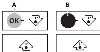
Для обеспечения надлежащего хранения продуктов холодильник оснащен индикатором температуры. Символ на боковой стенке прибора обозначает область максимального холода в холодильнике. Она находится между двух стрелок.
