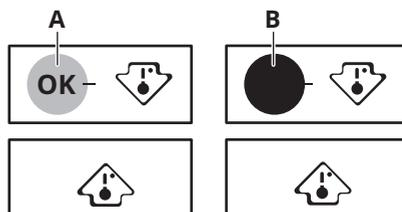
Toidu õigeks säilitamiseks on külmik varustatud temperatuuri indikaatoriga. Seadme külgseljal kahe noole vahel asuvad sümbolid näitavad, milline on külmiku kõige külmema ala.
