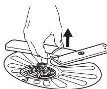
Um den unteren Sprüharm zu entfernen, ziehen Sie ihn nach oben.
