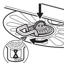
Remettez le filtre plat (A) en place. Assurez-vous qu'il est correctement positionné sous les 2 guides (D).
