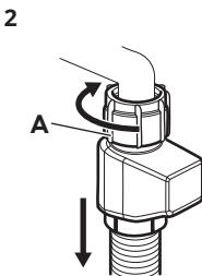
Nehmen Sie den Schlauch ab. Drehen Sie die Halterung **A** nach rechts.
