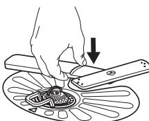
Per re-installare il mulinello inferiore, premerlo verso il basso.
