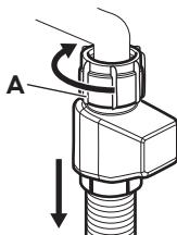
Scollegare il tubo. Ruotare il dispositivo di serraggio **A** in senso orario.
