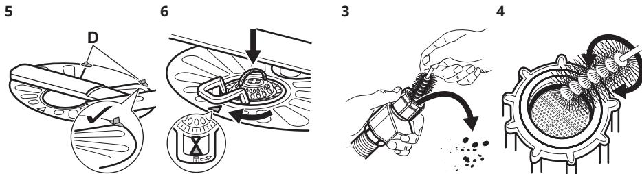
Setzen Sie das flache Sieb (**A**) wieder ein. Stellen Sie sicher, dass es korrekt unter den beiden Führungen (**D**) eingesetzt wurde.
