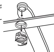
Drehen Sie das Montageelement gegen den Uhrzeigersinn und ziehen Sie den Sprüharm nach unten.
