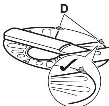
Vuelva a colocar el filtro plano (A). Asegúrese de que está colocado correctamente en las dos guías (D).
