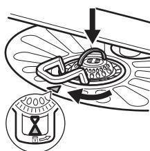
Vuelva a montar los filtros (B) y (C). Póngalos de nuevo en el filtro (A). Gire el asa en la dirección de las agujas del reloj hasta que encaje.
