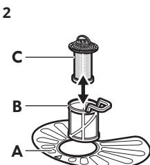
Il sistema del filtro si compone di tre parti.
