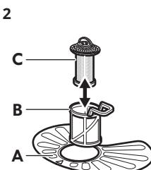
O sistema de filtração é composto por três peças.
