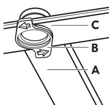
Der Sprüharm (**C**) ist im Überleitungsrohr (**A**) mit dem Montageelement (**B**) montiert.
