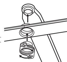
Setzen Sie das Montageelement in den Sprüharm und befestigen Sie ihn am Überleitungsrohr, indem sie ihn im Uhrzeigersinn drehen. Achten Sie darauf, dass das Montageelement einrastet.
