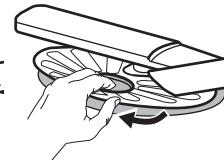
Entfernen Sie das flache Sieb (A). Reinigen Sie das Sieb mit Wasser.
