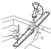
Reinigen Sie den Sprüharm unter fließendem Wasser. Entfernen Sie Verunreinigungen aus den Öffnungen des Sprüharms mit einem spitzen Gegenstand, z.B. einem Zahnstocher. Lassen Sie Wasser durch die Austrittsöffnungen laufen, um Verschmutzungen aus dem Inneren zu entfernen.
