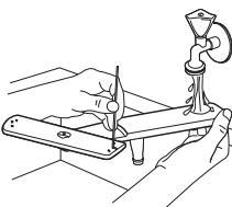
Lave o braço aspersor em água corrente. Utilize um objecto fino e pontiagudo, por exemplo um palito, para remover a sujidade dos orifícios.
