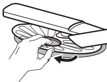
Per rimuovere i filtri (B) e (C) ruotare la maniglia in senso antiorario ed estrarla. Estrarre il filtro (C) dal filtro (B). Sciacquare i filtri con acqua.
