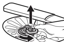
Zum Entfernen der Siebe (B) und (C) drehen Sie den Hebel gegen den Uhrzeigersinn und heben Sie die Siebe heraus. Nehmen Sie das Sieb (C) aus dem Sieb (B). Reinigen Sie die Siebe mit Wasser.
