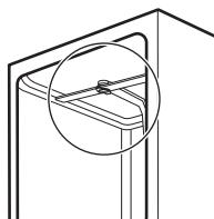
Der Deckensprüharm ist an der Decke des Geräts angebracht.
