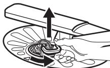
Para retirar los filtros (B) y (C), gire el asa en la dirección opuesta a las agujas del reloj y tire hacia arriba. Extraiga el filtro (C) del filtro (B). Lave los filtros con agua.
