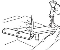
Reinigen Sie den Sprüharm unter fließendem Wasser. Entfernen Sie Verunreinigungen aus den Öffnungen des Sprüharms mit einem spitzen Gegenstand, z.B. einem Zahnröhrchen.
